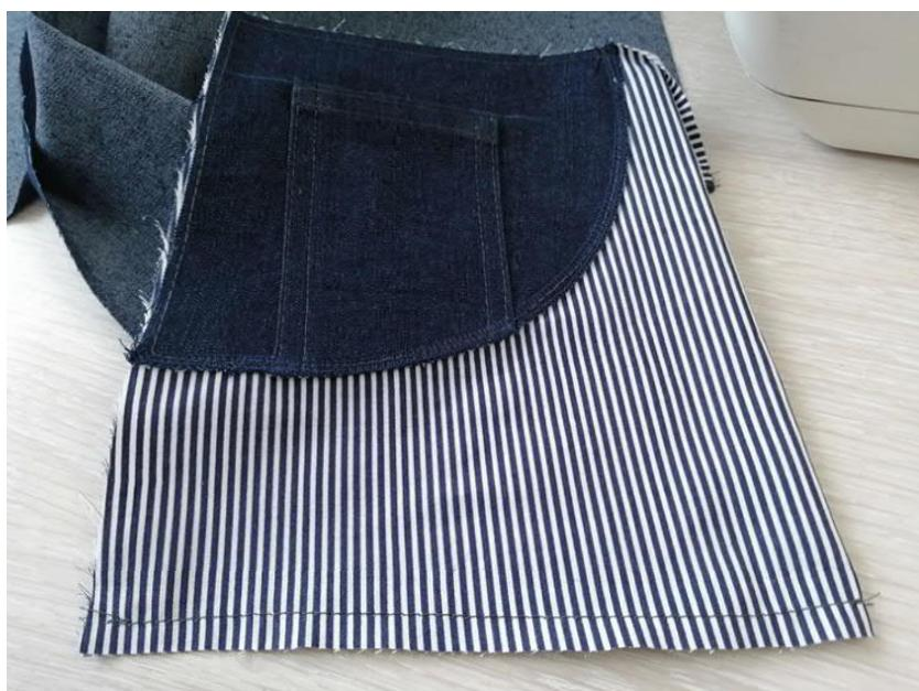
Выворачиваем карман и прокладываем строчку, запаковывающую припуск внутри.
