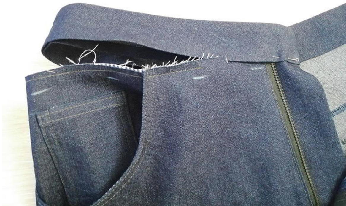
На деталях пояса стоят отметки середины и боковых швов. Соединяем отметки и скальваем детали.
