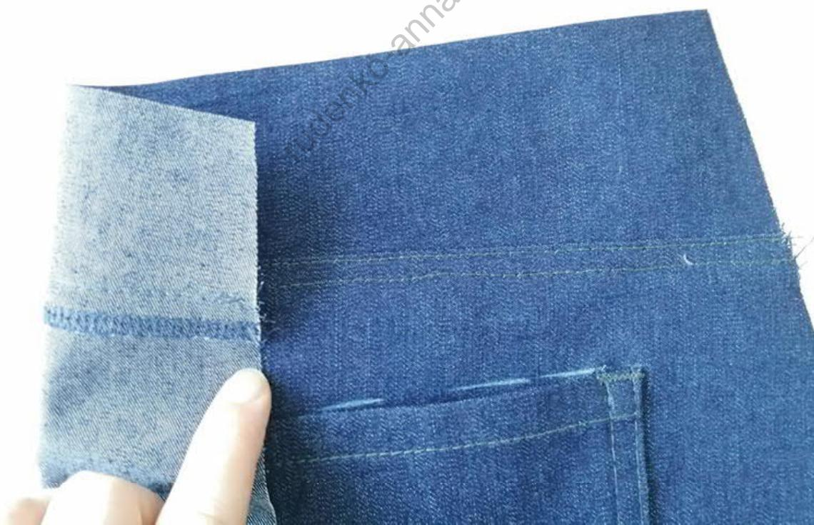
Сшиваем средний шов, обметываем. Припуски отворачиваем на левую половинку (свертесь с передней частью, чтобы припуски смотрели в одну сторону). Делаем двойную отстрочку.
