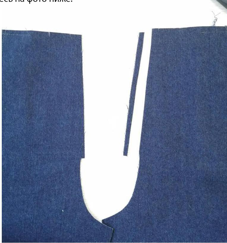
К брючине без выступа пришиваем обтачку. Отворачиваем, утюжим и отстрачиваем близко к краю.
