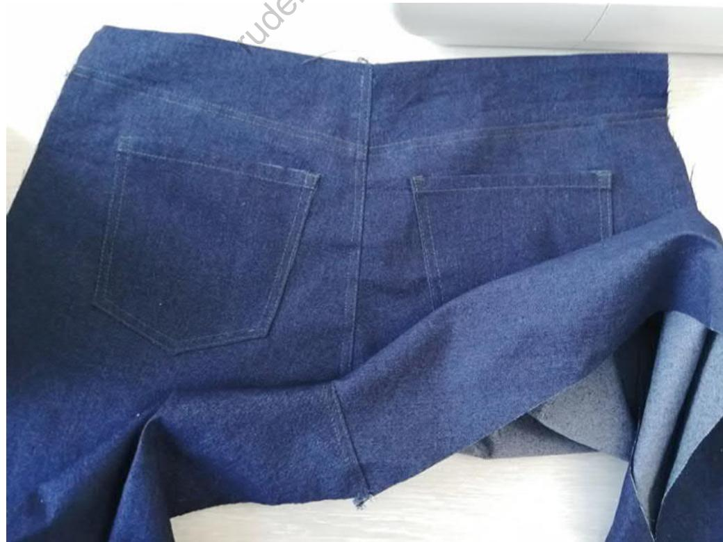
Выполняем шаговые швы одной строчкой. Обметываем припуски и делаем двойную отстрочку. Потяните немножко шаговые швы под утюгом.
