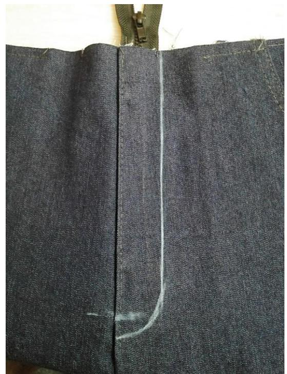
Переворачиваем брюки. Откосок старательно подворачиваем, чтобы не попал под двойную отстрочку, которую будем выполнять.
