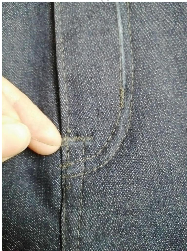
Задние половинки складываем вместе брызгаем водой и слегка растягиваем как показано на фото ниже. Ставим на край утюга и как бы вытягиваем из-под него, а утюгом двигаемся по краю. Должен получиться слегка волнистый край.
